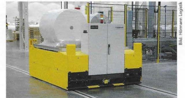
Querverteilerwagen mit integrierter Powercap-Technologie.
