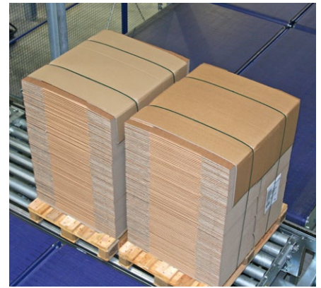
Pärchentransport auf Rollen- und Kunststoffkettenförderern.
