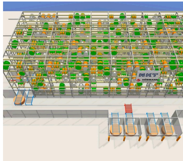
Abbildung 2 Erneuerung der Fördertechnik am automatisierten Drahtlager
